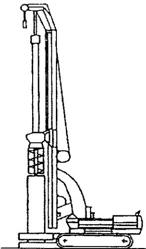
Hình A1.2.4 Máy khoan cọc nhồi chuyên dụng với cơ cấu xoay hạ ống vách.
