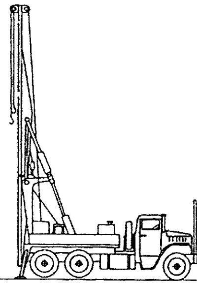
Hình A1.4.1 Máy đóng cọc
