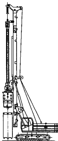
Hình A1.2.2 Máy khoan cọc nhồi chuyên dụng với càn khoan Kelly và gầu khoan
