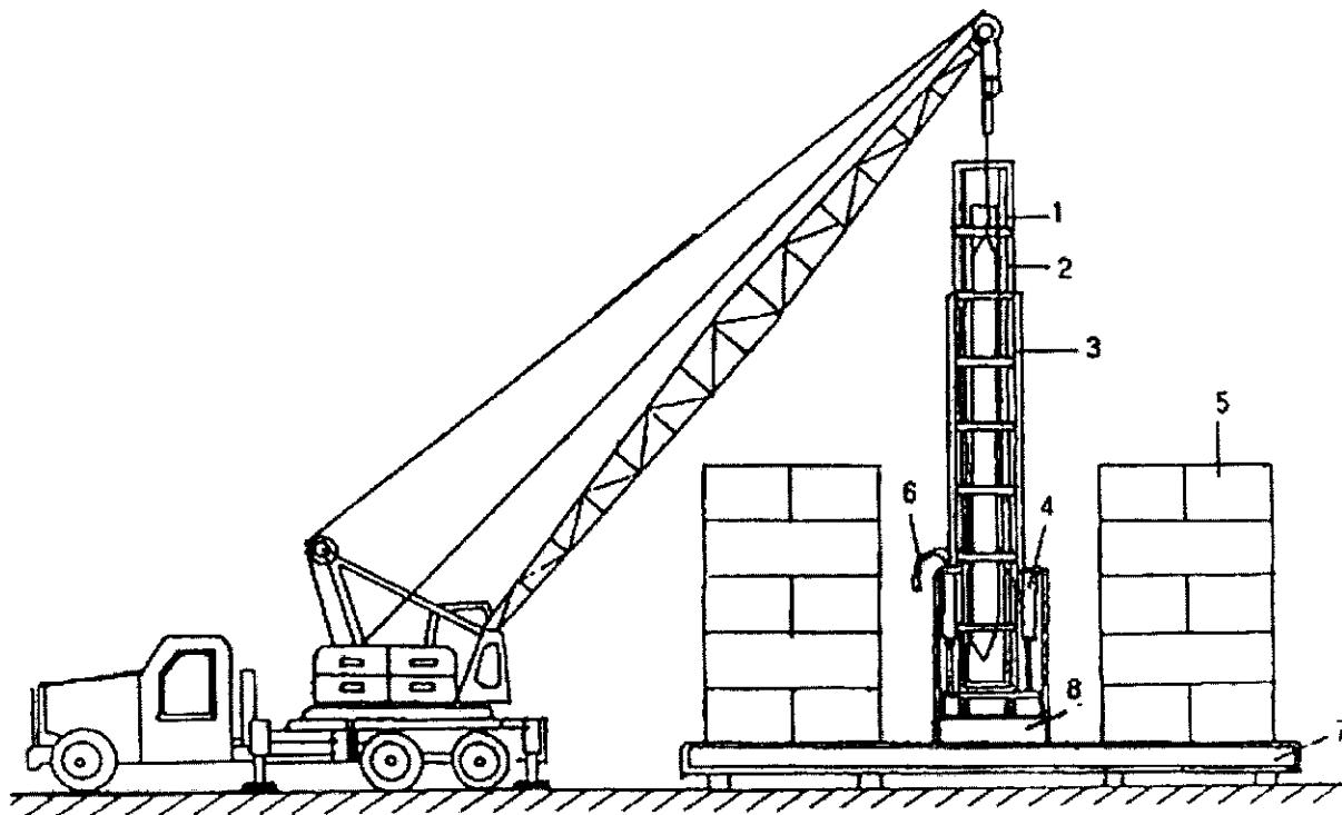
Hình A2.1 Máy ép đinh: 1 - Cọc ép; 2 - Khung dẫn hướng di động; 3 - Khung dẫn hướng cố định; 4 - Xi lanh ép; 5 - Đồi trọng (tải); 6 - Ống mềm dẫn dầu thủy lực; 7 - Khung chính; 8 - Khung phụ
