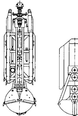
Hình A1.3.2 Gầu ngoặt dùng để thi công tường trong đất, có thể được treo tự do trên cáp hoặc được dẫn theo một dẫn hướng, đóng mở gầu bằng thủy lực hoặc bằng cáp
