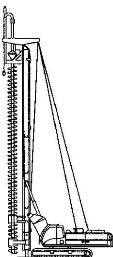
Hình A1.2.1 Máy khoan cọc nhồi chuyên dụng với càn khoan dạng vít liên tục (CFA)
