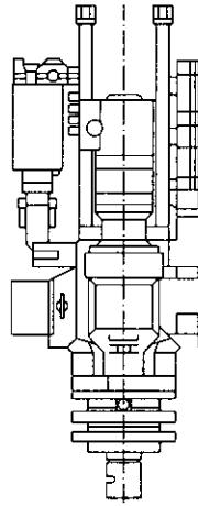
Hình A1.2.9 Búa khoan kiểu xoay va đập
