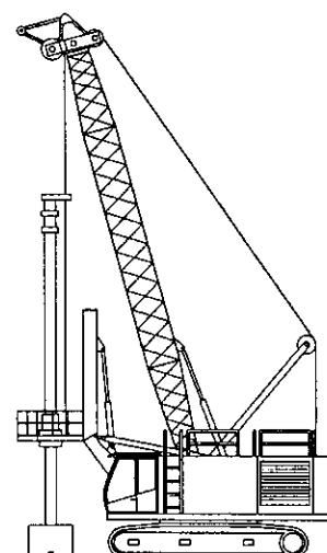
Hình A1.2.3 Máy khoan cọc nhồi bán chuyên dụng với cơ cấu khoan lắp trên càn trục bánh xích
