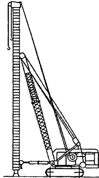
Hình A1.4.2 Máy đóng cọc
