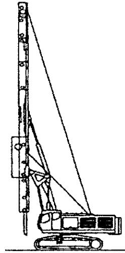
Hình A1.2.6 Máy cắm bắc thẩm bánh xích
